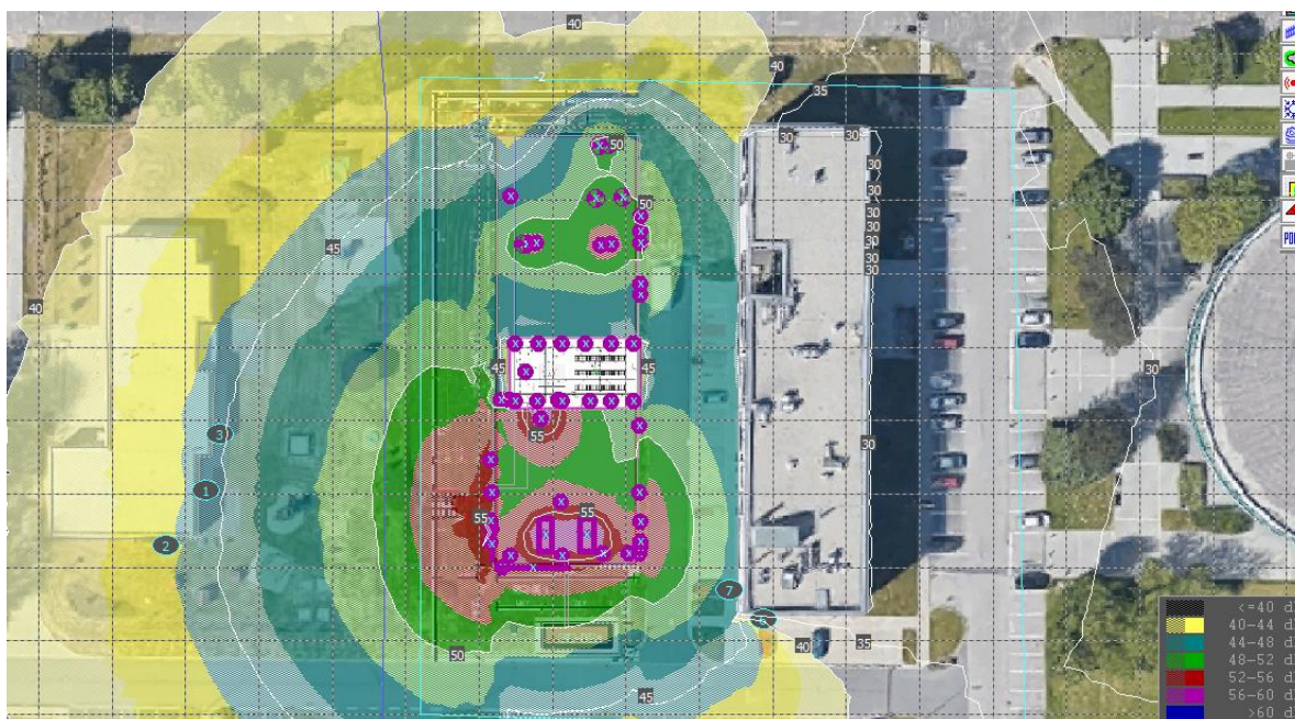
Obr. č. 7 vykreslení izofonových pásem ve výšce 14 m nad terénem
